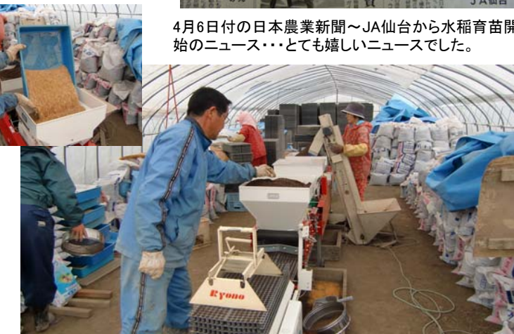
高速播種機「みのる君」で種と土をバランスよく育苗ポットに入れていきます。(4月14日)
