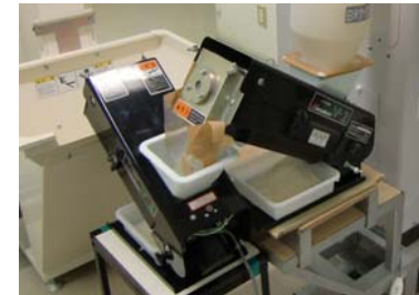
③精米機を通過した米はこの「小米取り機」へ。この機械は「割れ米」などを取り除く機械。製品に「割れ米」が混じると食味を損ねるため、この機械を設置。通常は1台セットするところ、2台連結することで、より精度を高めるよう工夫しています。
