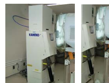
①最初に玄米が投入されるのがこの「石抜き機」。製品に小石など異物が混入するのを防ぎます。
