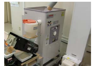
②「石抜き機」を通過した玄米はその後「精米機」へ。形は小さいけれど高性能な機械です。
