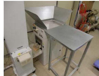
①最初に玄米が投入されるのがこの「石抜き機」。製品に小石など異物が混入するのを防ぎます。
