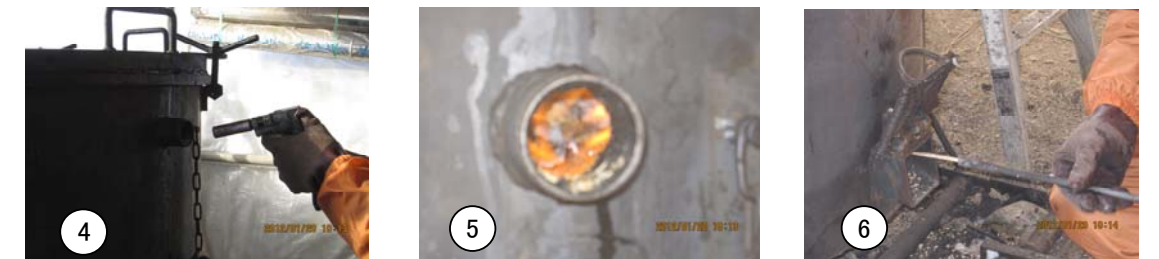
④ライターで点火 ⑤着火を確認 ⑥下まで火が通ったかを後で確認するために、割り箸などを最下部に装填する
