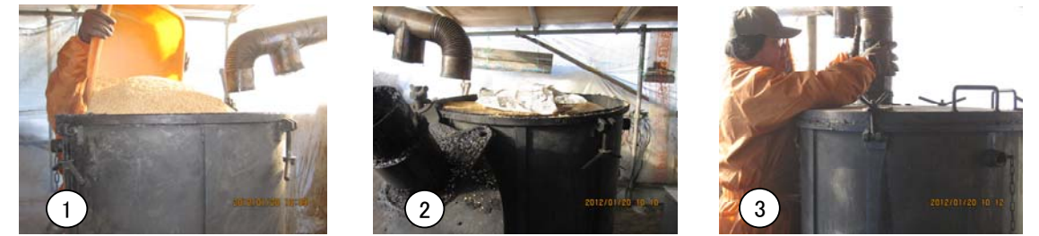
①くん炭製造機に「籾殻」を投入 ②着火しやすいように新聞紙などを上に乗せる ③蓋をして密閉し、煙突を装着する
