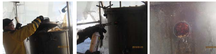
一杯になったところで蓋をして密閉しバーナーで着火します(1月23日) 着火を確認(1月23日)
