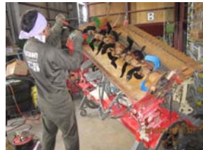
代かきロータリーの修理(7月14日)
