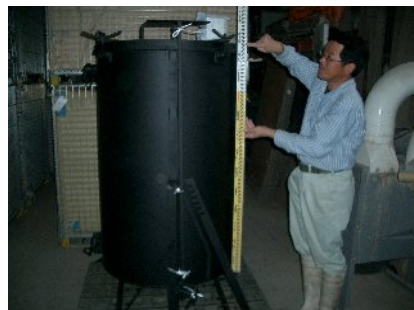
これは籾殻をくん炭にする器械です。昨年の10月に購入しました。
