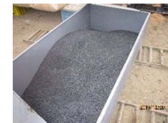
出来上がったくん炭はこの鉄箱で冷ます 点火してから、仕上がりまで約7時間近くをかけて籾殻の「くん炭」が出来上がります。
