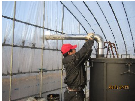
昨年12月5日、ビニールハウスの中にくん炭製造器を設置しました。容量は約560リットルあります。この器械で冬の間せつせと籾殻くん炭を作ろうと考えています。
