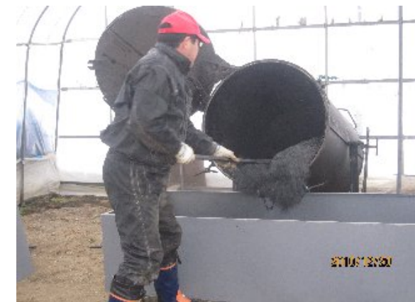
出来上がったくん炭はこの鉄箱で冷ます 点火してから、仕上がりまで約7時間近くをかけて籾殻の「くん炭」が出来上がります。
