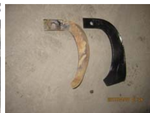
ロータリーの歯の取り換え作業(左)と歯の摩耗状態の新旧比較(4月7日)
