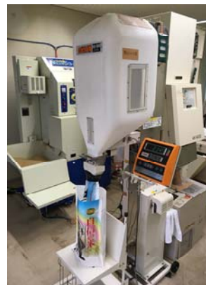
精米システムです。手前の機械が計量機と色彩選別機、奥に見えるのが精米機「美白米スター」です。写真からは判りづらいですが、精米機の右隣に小米取り機もあります。
